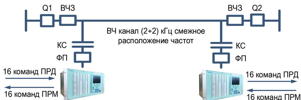
Рисунок 12 – Дуплексная передача и прием до 16 команд РЗ и ПА в полосе 4 кГц (при смежном расположении частот)
