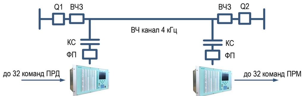
Рисунок 14 – Симплексная передача до 32 команд РЗ и ПА в полосе 4 кГц
