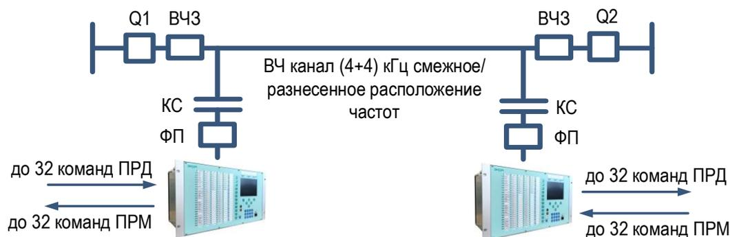
Рисунок 13 – Дуплексная передача и прием до 32 команд РЗ и ПА в полосе (4+4) кГц (при смежном или разнесенном расположении частот)
